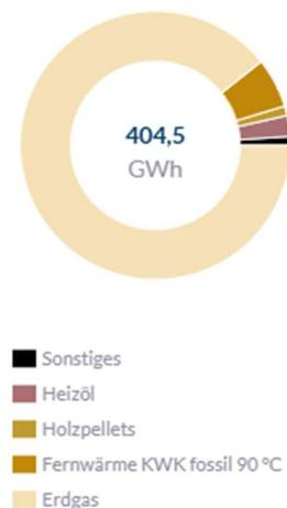
Abbildung 32: Aufteilung des Wärmebedarfes (Nutzenergie) auf die Energieträger zur Wärmeversorgung
