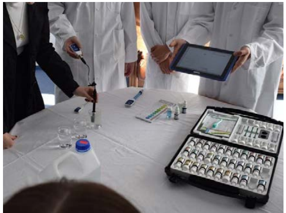
Bestimmung der Leitfähigkeit von Flüssigkeiten durch das Team des Fördervereins der SBBS.
